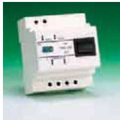
Telemando MD-145 Realización de pruebas colectivas de funcionamiento en presencia de Red, a pilotos de señalización 18545. Puesta en estado de reposo de los mismos en ausencia de Red. Alimentación 230V 50-60 Hz. Batería de Ni-Cd recargable incorporada. Nº máx. de pilotos: 50. Instalación sobre perfil simétrico DIN 46277 (EN 60715). Dimensión: 4 módulos DIN de 17'5mm.
